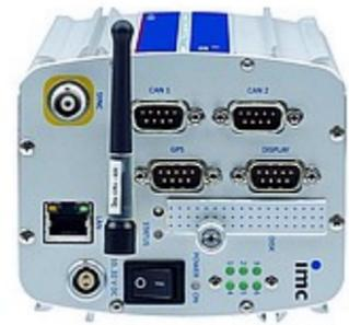
Il sistema di acquisizione **imc C-SERIES**, viene utilizzato all'interno di una particolare Boa, realizzata dal **Centro di Supporto e Sperimentazione Navale (CSSN)** della Marina Militare, per acquisire, processare in tempo reale e trasmettere via link RF, oltre alla time-history del segnale, lo spettro del rumore rilevato da Unità Navali in prova, tramite opportuni idrofoni.
