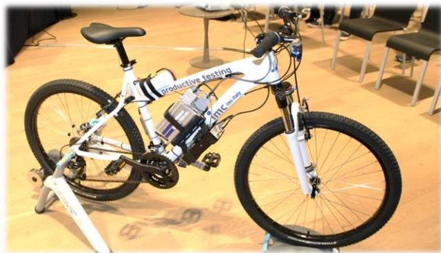
imc BIKE è una normale bicicletta, strumentata da **imc-Italy** con un'unità di acquisizione ed analisi dati della famiglia imc e con una serie rappresentativa di sensori di misura normalmente impiegati nel R&D e nella sperimentazione meccanica. Rappresenta la sintesi di un banco prova sul quale, a scopo didattico, sono state dimostrate e verificate in modo pratico e diretto le capacità e la flessibilità offerte dalle soluzioni imc.
