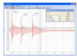
vibrazione, in questo caso, è stata contemporaneamente acquisita sia su memoria a bordo strumento che su PC. I dati salvati sono stati visualizzati con FAMOS ed esportati in file ASCII per consentire ulteriori post-elaborazioni necessarie all'utente finale.
