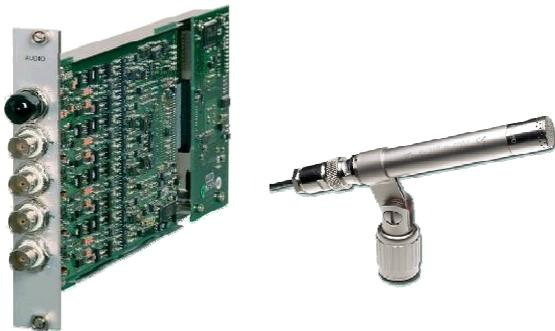
*imc AUDIO2-4 è un modulo quadricanale per microfoni ICP/IEPE, comune ai dispositivi di acquisizione imc C-SERIES e imc CRONOS. imc AUDIO2-4-MIC è la versione per microfoni convenzionali.*
