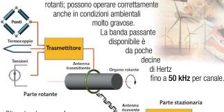
Oltre che da sensori estensimetrici e ponti di misura accettano segnali in tensione, da trasduttori IEPE e da sonde di temperatura.
