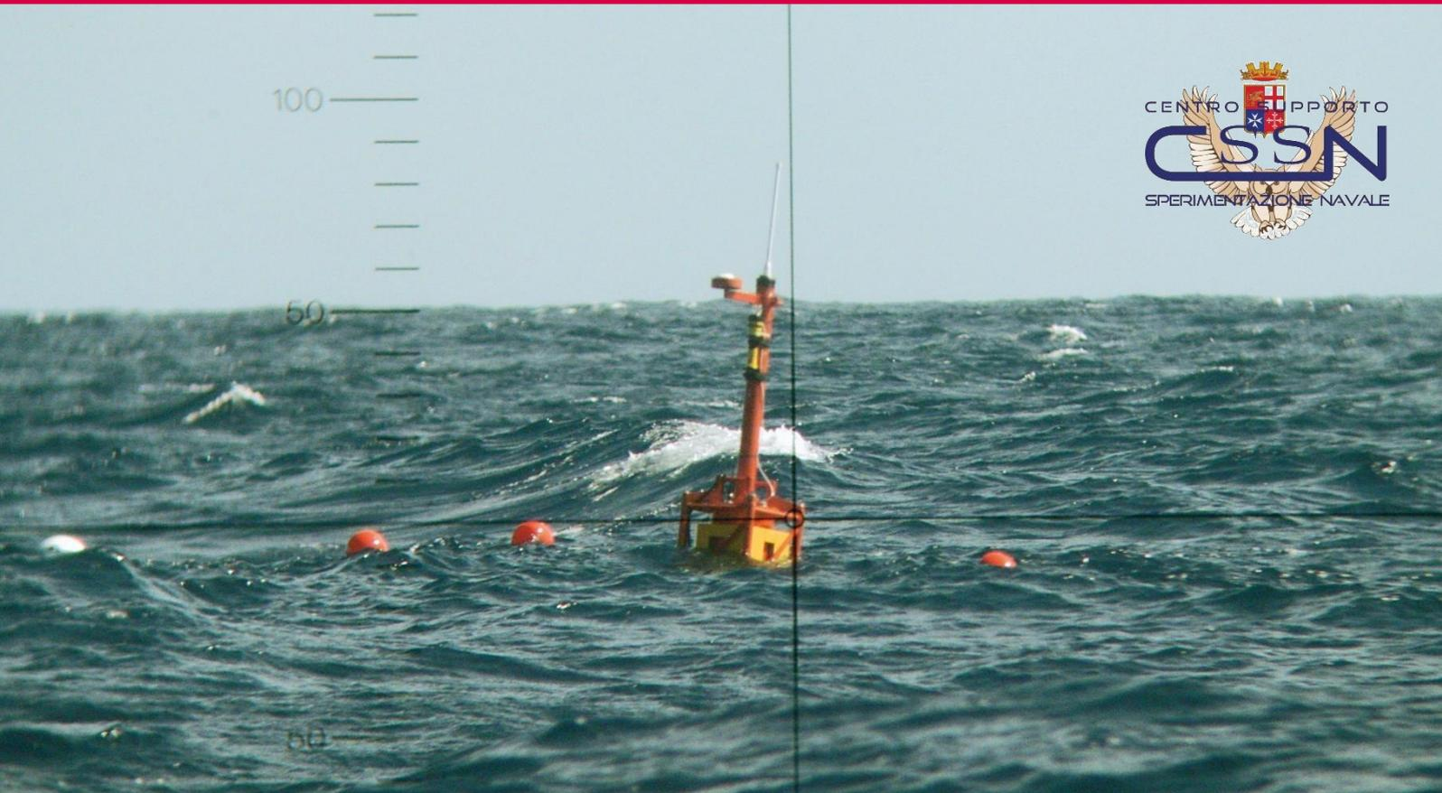
In questa nota applicativa viene illustrata la soluzione utilizzata per il rilievo delle emissioni acustiche di Unità Navali di Superficie e Subacquee tramite l'impiego del **"Sistema Autonomo per Rilievi Acustici"** (SARA); attività svolta dalla **Marina Militare Italiana** presso il **"Centro di Supporto e Sperimentazione Navale"** (CSSN) della Spezia.
